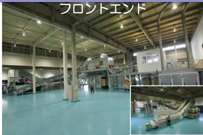
異素材選別・ラベル除去・粉碎の工程
